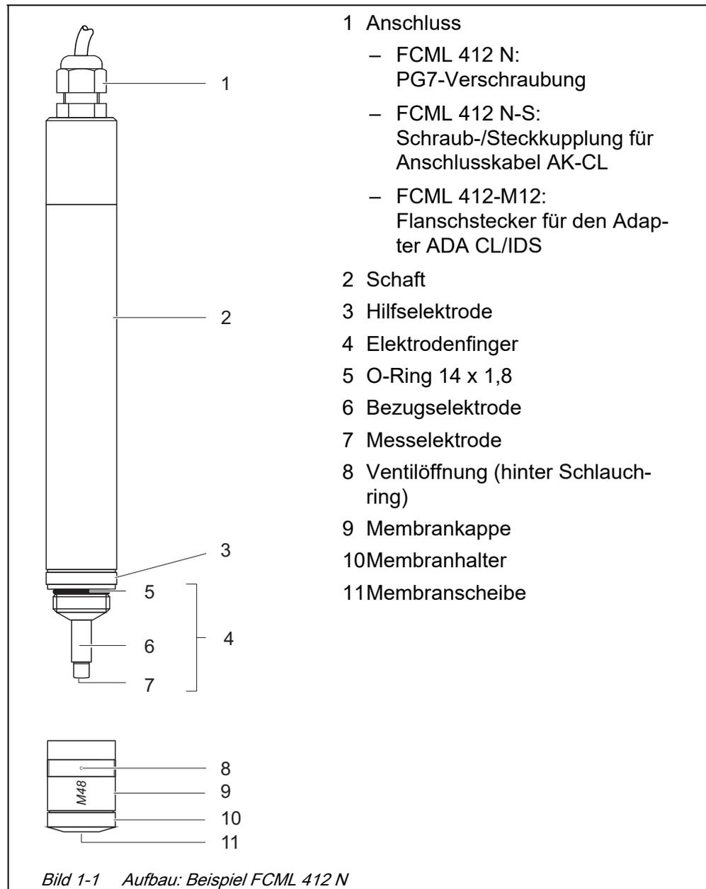
Durch die besondere Konstruktion (potentiostatisches 3-Elektrodensystem) erfasst der Sensor das gesamte frei verfügbare Chlor (Summe aus gasförmigem gelöstem Chlor, hypochloriger Säure und Hypochlorit) sowie an
