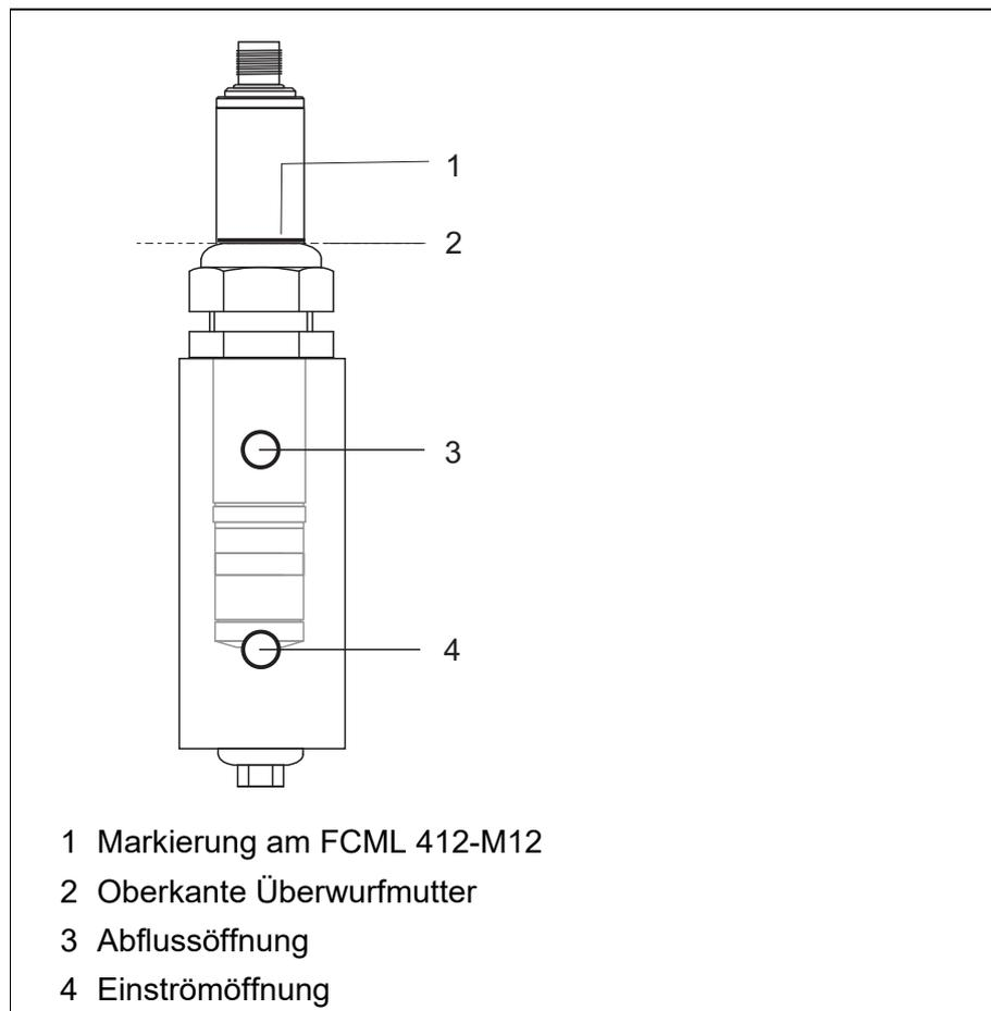
4. Die Markierung (1) am Sensor an der Oberkante (2) der Überwurfmutter ausrichten.
