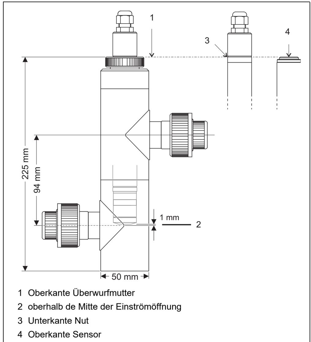
5. Die Überwurfmutter von Hand festziehen. Darauf achten, dass der Sensor fest sitzt. Er kann sonst bei Druck aus dem Durchflussgefäß gedrückt werden.
